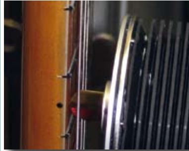
Mit dem plek scan erstellt die Maschine eine „digitale Landkarte“ des Griffbrettes.
